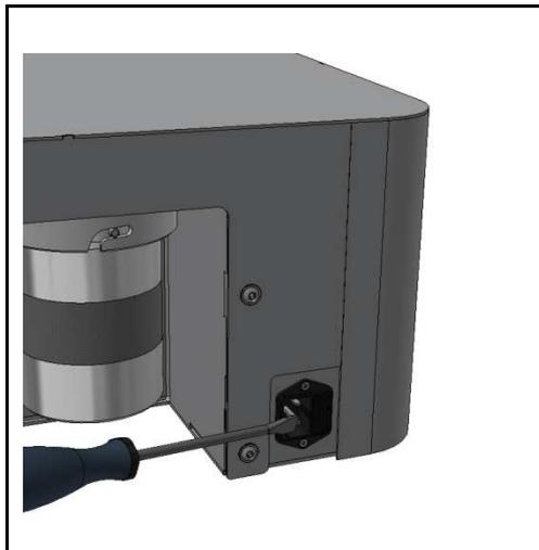
O fusível de vidro está localizado na parte traseira da máquina e está integrado no soquete. Para substituir o fusível, a bandeja deve ser aberta com uma chave de fenda adequada. O lado direito do soquete contém a bandeja com o fusível de vidro e pode ser puxado colocando a chave de fenda atrás da guia.
